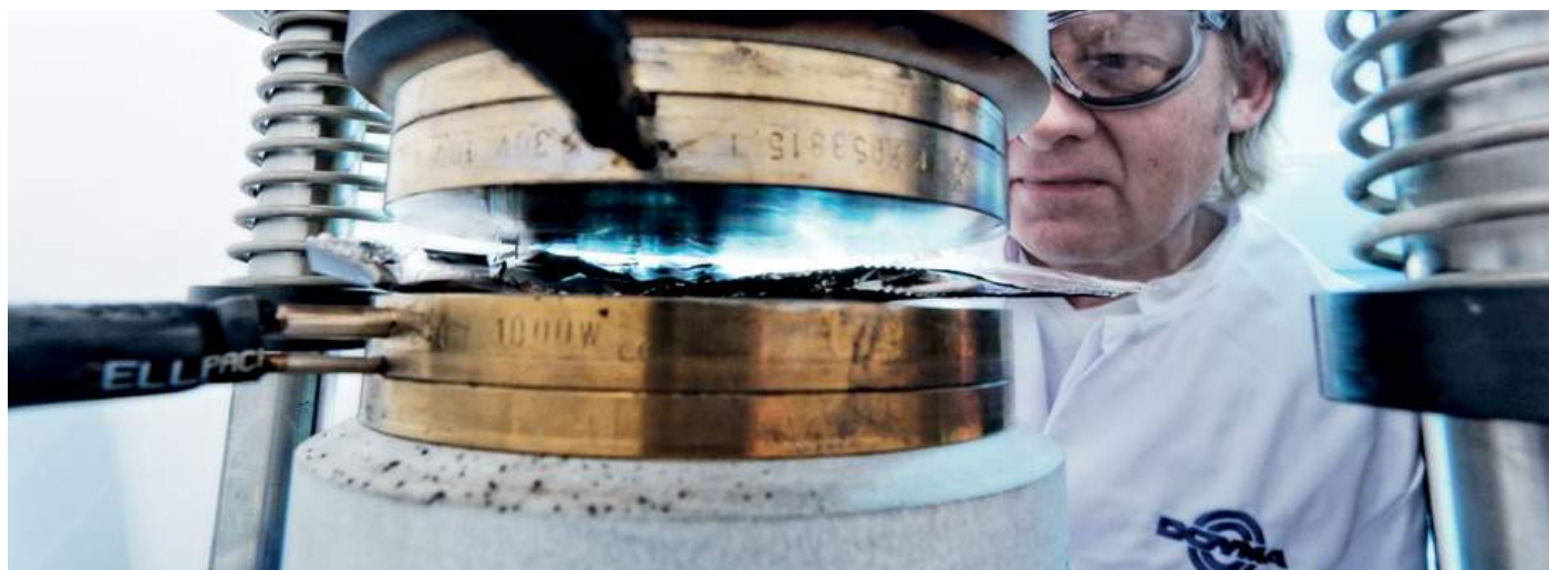
Mesure de la pression d'expansion de matériaux intumescents
