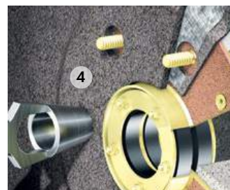
Découpe des trous avec le pointeau
